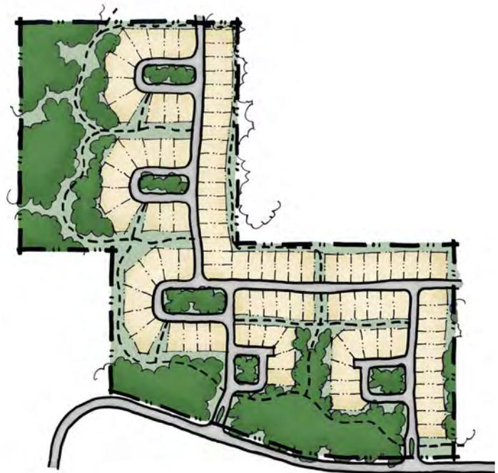
**FIGURE 3.5 LOOP AND GRID HYBRID STREET NETWORK**
