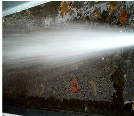
Chorro de limpieza sin mezcla de aire, corto alcance.
