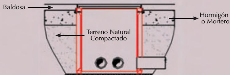
Plano del acabado de una arqueta HIDROSTANK colocada y recibida.
