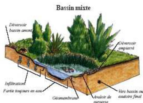
Figure 16 : Bassin mixte (source : CPA14)
