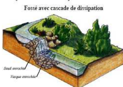
Figure 19 : Fossé à dissipation d'énergie (source : CPA14)
