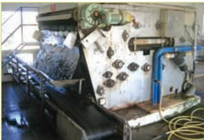
Foto 3.15. Secado mecánico de lodos: Filtros Banda. EDAR de Manilva (Málaga)
