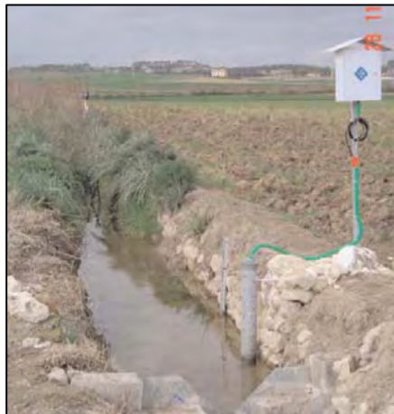
Estación de aforo en el torrente de Na Borges (Mallorca) para los estudios de caracterización hidrológica y transporte de sedimentos en la cuenca del torrente, realizado por el Departamento de Ciencias de la Tierra de la UIB
