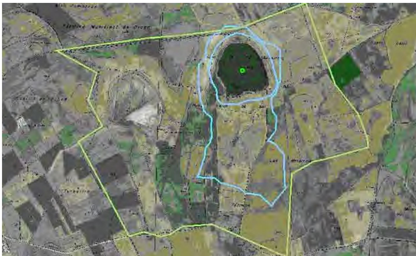
Ejemplo de aplicaciones Sistema de Información Geográfica (SIG) y Sistema Virtual de Decisión (SVD). Delimitación de la cuenca vertiente (línea azul) y zona de reserva (línea verde) del Humedal Hoya de la Ballestera (Osuna) mediante utilización de SIG y ortofoto digital. Proyecto LIFE "Humedales Sostenibles"
