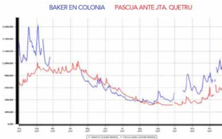
Figura A5-115: Hidrograma de caudales instantáneos registrados en las estaciones fluviométricas Baker en Colonia y Pascua Ante Junta Quetru (DGA, 2009)
