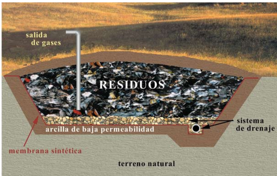
Sección esquemática de un depósito de seguridad de residuos
